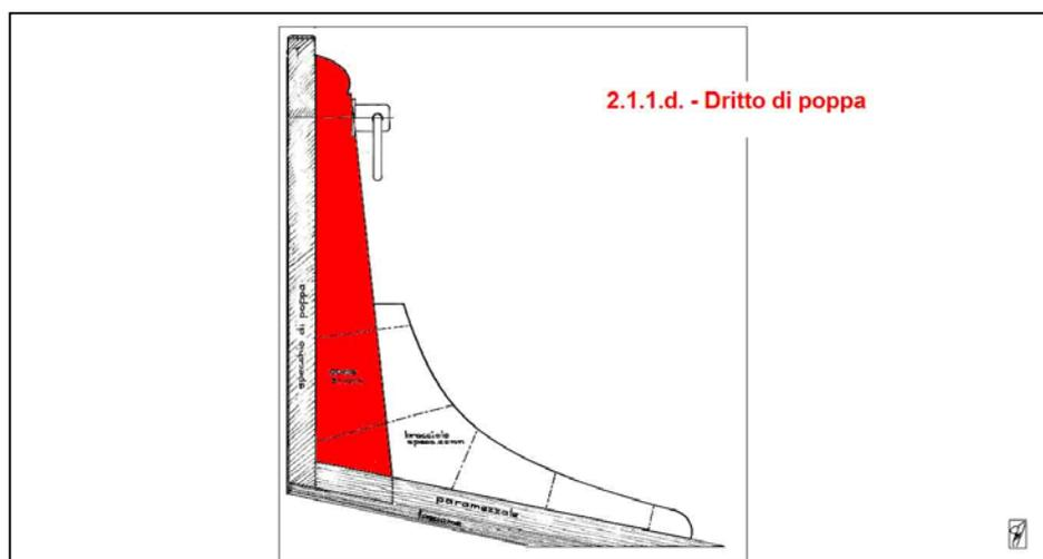
**Dritto di poppa** - Elemento strutturale che chiude lo scafo a poppa ed è congiunto alla chiglia tramite un altro elemento, detto vanticuore, con cui concorre a formare il calcagnolo. Nelle costruzioni navali antiche, e ancora oggi nelle più piccole, sul dritto di poppa sono connessi gli agugliotti (le cerniere) della pala del timone. (da: [www.sullacrestadellonda.it/terminologia/fterminolindex.htm](http://www.sullacrestadellonda.it/terminologia/fterminolindex.htm))
