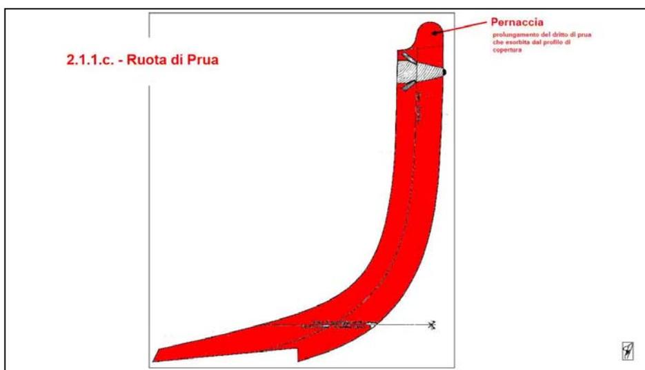
**Dritto di prua (o di prua)** - Elemento strutturale che chiude lo scafo a prora; è quasi sempre verticale o slanciato in avanti; inizia in basso con la ruota, prosegue col tagliamare in corrispondenza del galleggiamento e termina superiormente con forme diverse, non necessariamente diritte. (da: [www.sullacrestadellonda.it/terminologia/fterminolindex.htm](http://www.sullacrestadellonda.it/terminologia/fterminolindex.htm))
