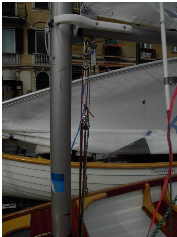
Caricabasso molto demoltiplicato e base rinviata in coperta
