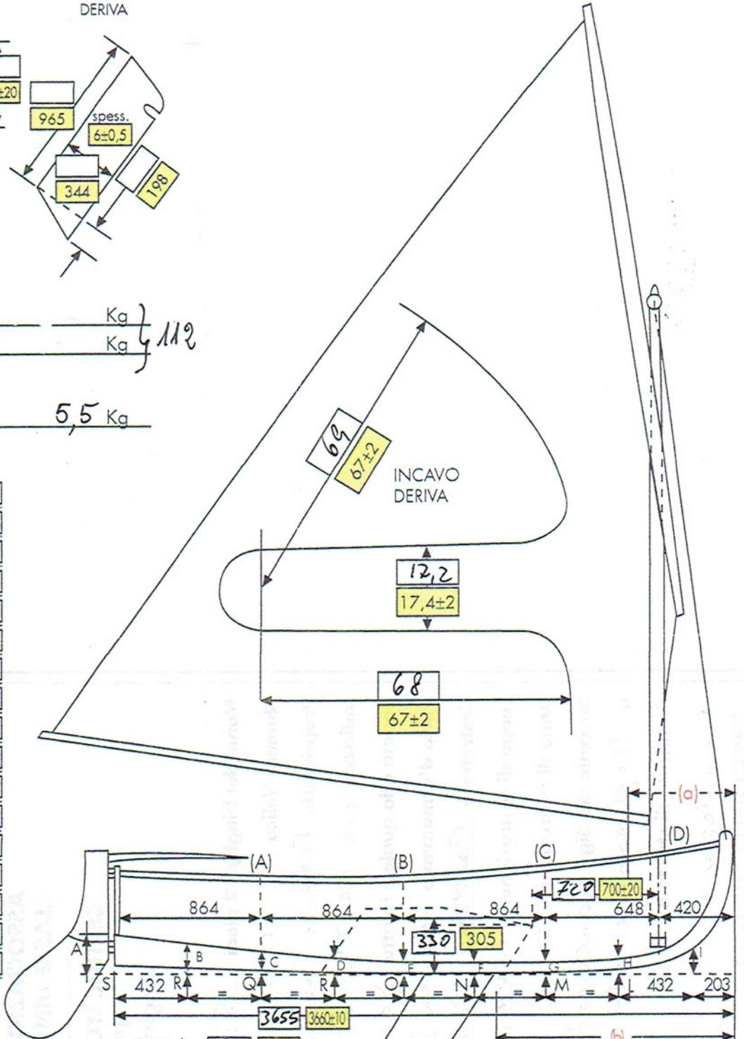
NB: A, B, C, D, E, F, G, H, I, L, M, N, O, P, Q, R, S, comprendono lo spessore del fascione (8 mm)
